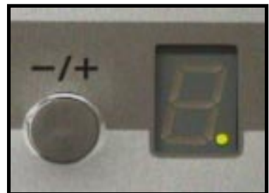
No final do Auto Teste e quando o produto for desligado pela tecla liga/desliga, os displays somente indicarão um ponto.
