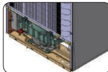
A limpeza do coletor não é necessária para o funcionamento do refrigerador. Caso queira efetuar a limpeza, desligue o refrigerador da energia elétrica retirando o plugue da tomada e utilize um pano úmido.
