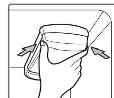
Puxe o filtro de água para baixo e rode-o no sentido anti-horário para o retirar. Certifique-se de rodar completamente o filtro para baixo antes de o puxar para fora do orifício do coletor.
