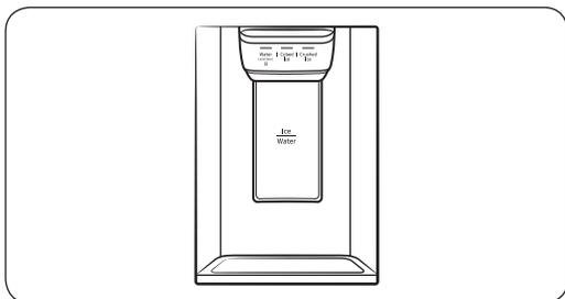
1. Com o Mecanismo de fabricação de gelo ativado, pressione **Cubed Ice (Gelo em cubo)** ou **Crushed Ice (Gelo picado)** para selecionar o tipo de gelo.
