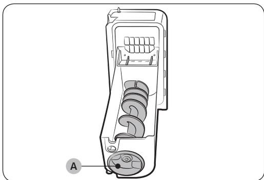
1. Para remover o cesto de gelo, gentilmente levante e puxe-o vagarosamente enquanto segura a parte inferior do cesto com uma das mãos e a lateral do cesto com a outra.
