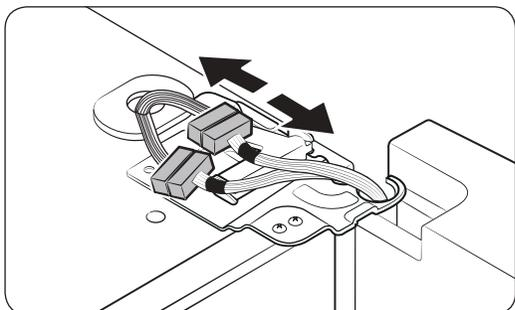
1. Desconecte os conectores de fios (x2) na porta direita. A posição dos conectores varia conforme o modelo.
