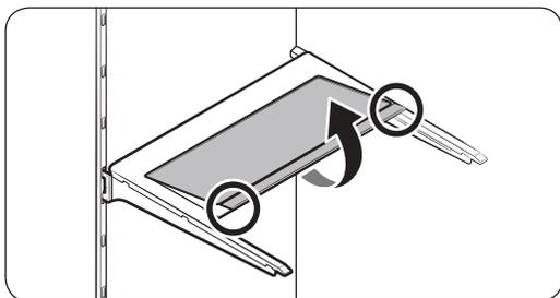
Para remover, deslize a frente da prateleira para que ela se dobre. Em seguida, levante gentilmente e retire-a. Para reinserir, coloque a prateleira na estrutura angulada na unidade principal e, em seguida, pressione para baixo para desdobrar.
