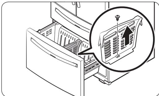
Solte e remova o parafuso do lado inferior da divisória. Em seguida, puxe-o para fora para remover a divisória.
