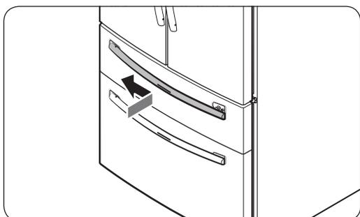
6. Para acoplar o puxador do freezer ao refrigerador, primeiro coloque o lado esquerdo do puxador no parafuso esquerdo do puxador.
