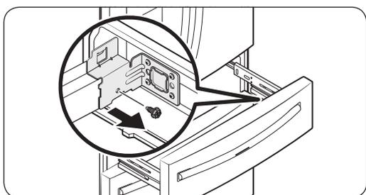
4. Remova o parafuso sextavado em cada lado da gaveta usando uma chave de soquete de 10 mm.
