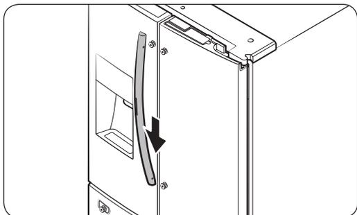
3. Empurre o puxador para baixo e, em seguida, coloque o lado superior do puxador no parafuso superior do puxador.
