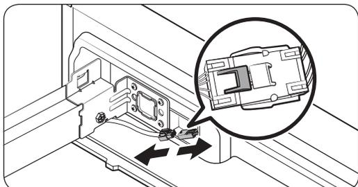
3. Pressione a **guia de trava** para desconectar o conector de fios.
