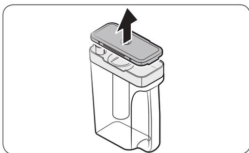
1. Segure uma ranhura do puxador da **boca vedada** e, em seguida, empurre para cima para remover.
