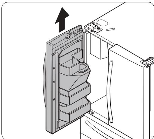
6. Levante gentilmente a porta verticalmente para remover. Não aplique força excessiva à porta. A porta pode cair e causar ferimento.
