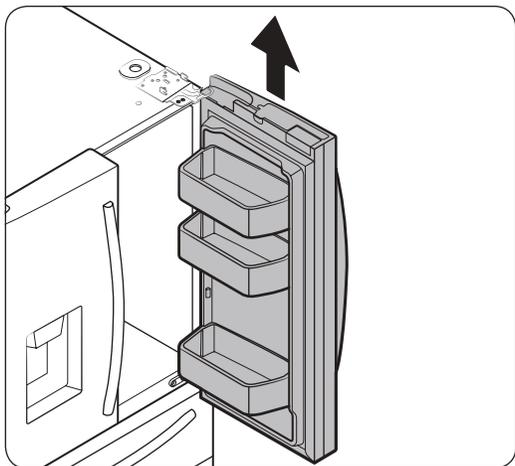
5. Levante gentilmente a porta verticalmente para remover. Não aplique força excessiva à porta. A porta pode cair e causar ferimento.
