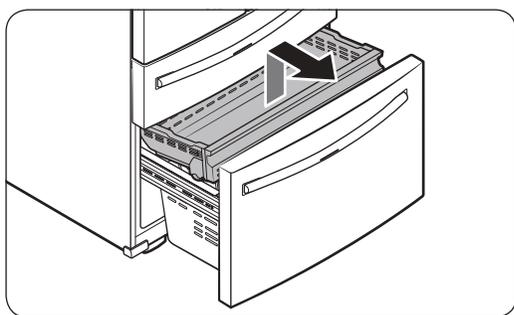
1. Empurre o **cesto superior** até o final e, em seguida, levante para remover.
