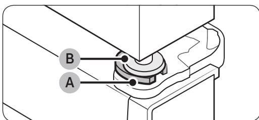
1. Verifique a diferença de altura entre as portas e, em seguida, levante e segure a porta com menor altura.
