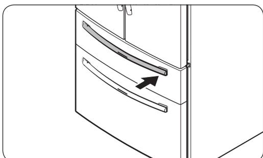
7. Empurre o puxador para a esquerda e, em seguida, coloque o lado direito do puxador do freezer no parafuso direito do puxador.
